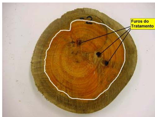
a - Disco de madeira onde foi aplicado indicador de difusão do Boro.
