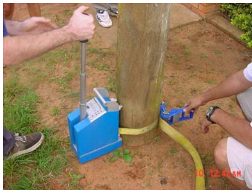
a - Fixação do aparelho ao poste.
