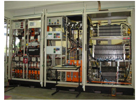
Fig. 2 Rack fechado (4m 2 ) e aberto com Células a Combustível (direita), módulo de controle (centro) e módulo de eletrônica de potência (esquerda)
