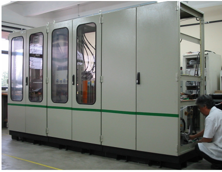
Fig. 2 Rack fechado (4m 2 ) e aberto com Células a Combustível (direita), módulo de controle (centro) e módulo de eletrônica de potência (esquerda)
